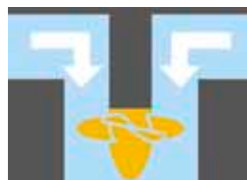
Über die verstellbaren Schaufeln bei Kaplan-turbinen lässt sich in Abhängigkeit der Durchflussmenge der Wirkungsgrad optimieren.
