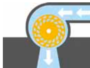
Francisturbinen kommen in Wasserkraftwerken mit mittlerer Fallhöhe zum Einsatz.
