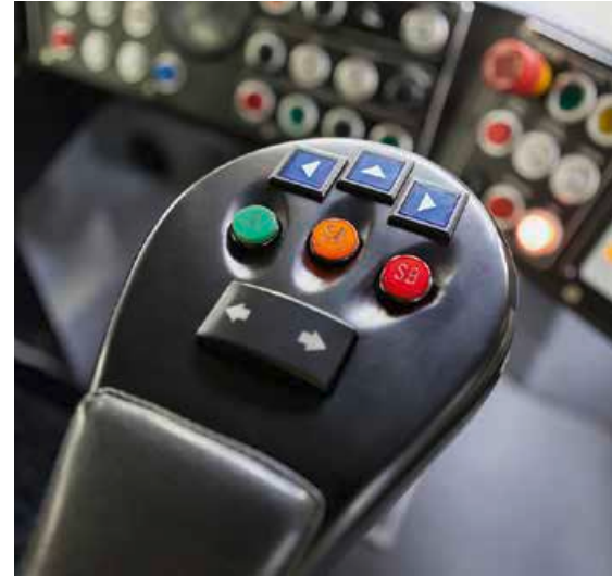
Armlehne nach Maß: Kleinserienproduktion bei der Ulmer Straßenbahn dank FDM (Fused Deposition Modeling) von Stratasys
